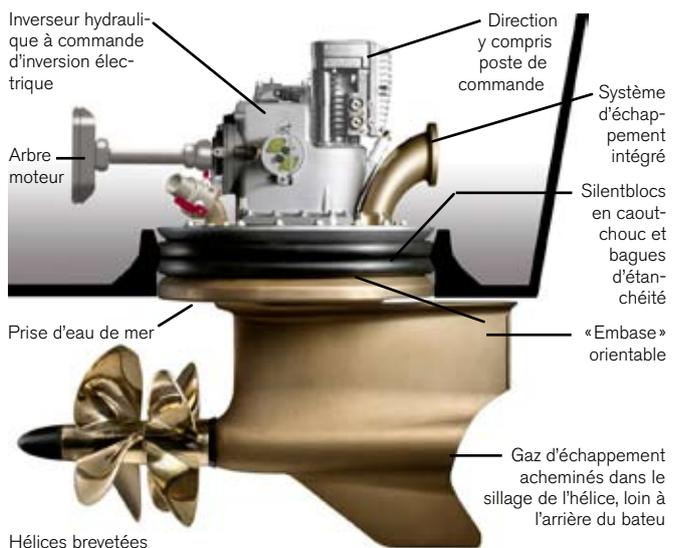
L'IPS Volvo Penta a été développé et conçu comme un système complet incluant toutes les unités - moteur, groupe de propulsion avec transmission, hélices, circuits d'échappement et d'eau de mer, direction et commandes.
